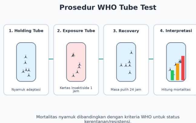
Gambar 13.1 Prosedur Standar Uji Resistensi Insektisida Menggunakan Metode WHO Tube Test
