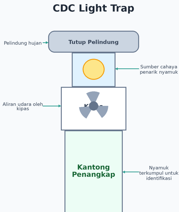
Gambar 6.1 Skema Komponen Utama Perangkap Cahaya (CDC Light Trap)
