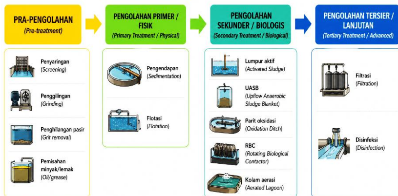
Gambar 4.2 Alternatif Tahapan Pengolahan Air Limbah Domestik
